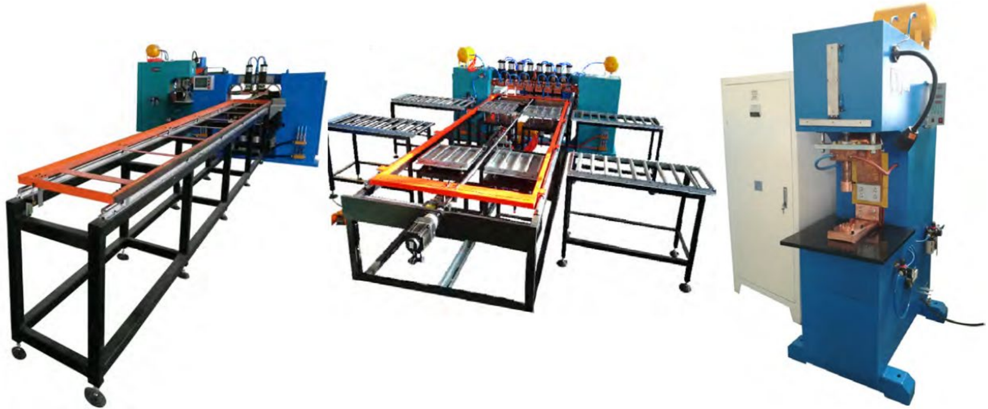
Автоматическая среднечастотная многоэлектродная сварочная машина для сеток (панелей)
