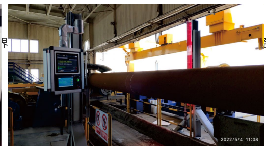
Визуальное измерение сверхбольших диаметров
