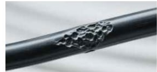
Дефекты поверхности проволочных изделий
