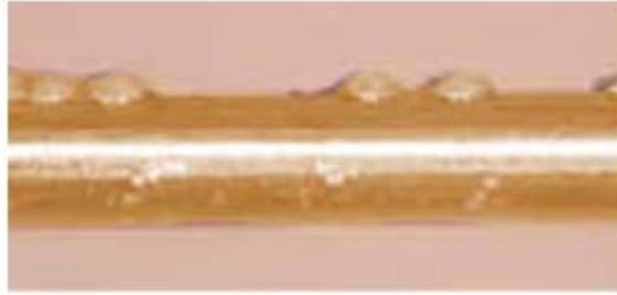
Обнаружение выступающих частиц на поверхности эмалированной проволоки
