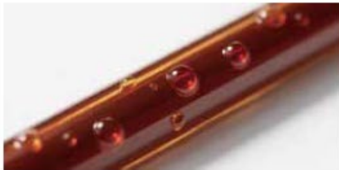
Обнаружение выступающих частиц на поверхности эмалированной проволоки
