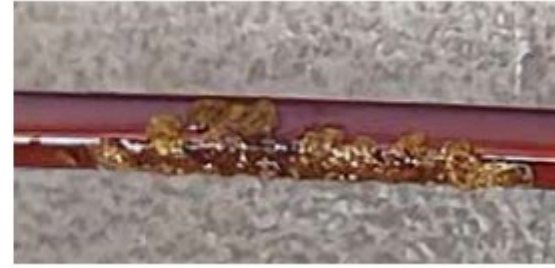
Непрерывные дефекты поверхности эмалированной проволоки
